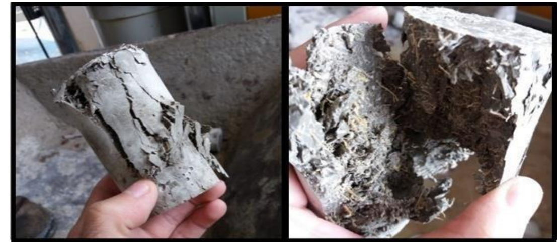
Figura 5 - Corpo de prova após ensaio de compressão.
